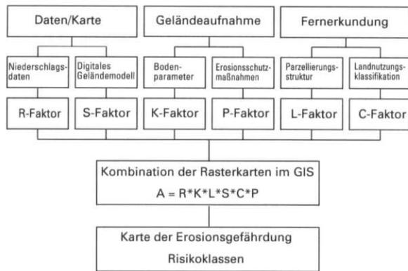
Abb. 1: Ablaufschema der Modellierung
