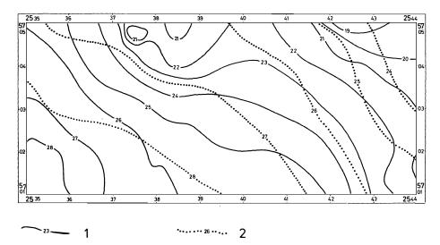
Abb. 4: Absinken des Grundwasserspiegels im Raum Moers. Linien gleichen mittleren Grundwasserspiegels in Metern über NN, 1 = Mittel von Nov. 1955 - Okt. 1965, 2 = Mittel von Dez. 1908 bis März 1910. Die Mittelwerte wurden aus monatlichen Pegelablesungen errechnet.
