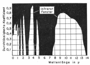
Abb. 2: Durchlässigkeitsspektrum der Atmosphäre (nach PARKER, in Lit. 47)
