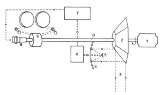
Abb. 3: Schema eines IR-Abtastgeräts 1 Antriebsmotor; 2 prismat. Mehrzellenspiegel; 3 einfallende Strahlen; 4 Hohlspiegel mit Loch; 5 Konvexspiegel; 6 Detektor; 7 Verstärker; 8 und 9 Anzeigegeräte (Neonröhre und Film)
