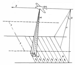
Abb. 5: Aufnahmetechnik mit IR-Abtastgeräten: 1 Flughöhe; 2 Flugrichtung; 3 Gesamtbreite des erfaßten Geländeausschnittes; 4 Winkelbreite des augenblicklichen Gesichtsfeldes; 5 augenblickliches Gesichtsfeld; 6 abgetasteter Geländestreifen und Abtastrichtung; 7 Lage des nächsten Flugstreifens für stereoskopische Überdeckung
