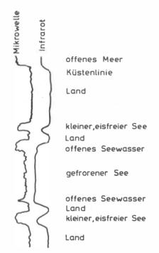
Abb. 6: Vergleich von IR und Mikrowellen-Geländeaufnahme (nach Skiles et al., in Lit. 47)
