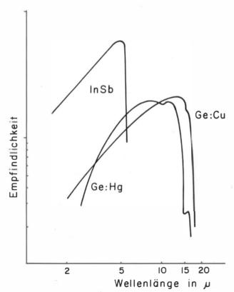
Abb. 4: Empfindlichkeitsspektrum einiger IR-Detektoren (nach Harris und Woodbridge)
