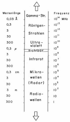
Abb. 1: Ausschnitt aus dem elektromagnetischen Spektrum
