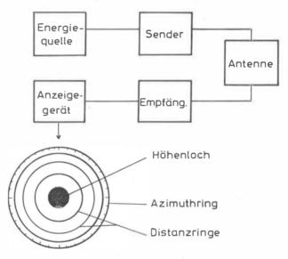
Abb. 7: Prinzip einer Radaranlage für die Lufterkundung mit PPI-Wiedergabe (nach Hoffmann, 1960)
