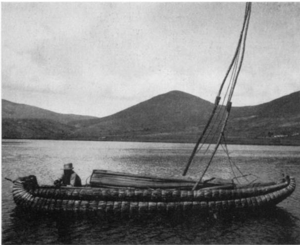
Abb. 3: Boot aus Binsenrollen gefertigt; Titicaca-See, mit Gabel zum Aufziehen des Segels. Segel eingerollt an Deck.
